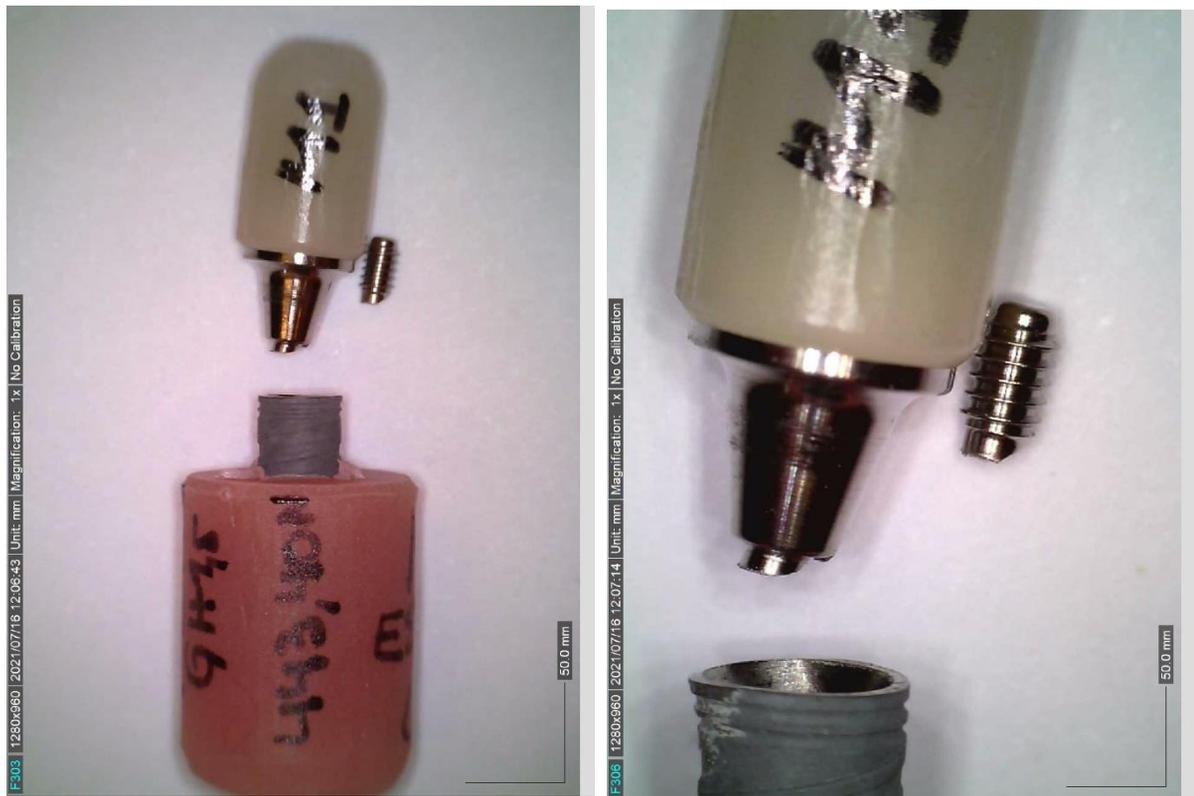
Imagen 4: Rotura de la primera muestra. Ensayo estático. (NB ActiveNP +NB Multi-Unit 4.8)
