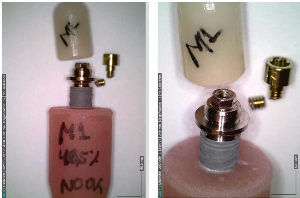
Imagen 7: Muestra de la resistencia a la fatiga de la prueba a la flexión por compresión con rotura del tornillo.
