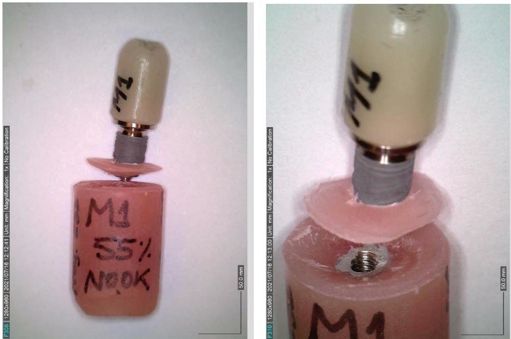
Imagen 6: Muestra de la resistencia a la fatiga de la prueba a la flexión por compresión con rotura del implante Nobel Active NP+ NB Multi-Unit 4.8.
