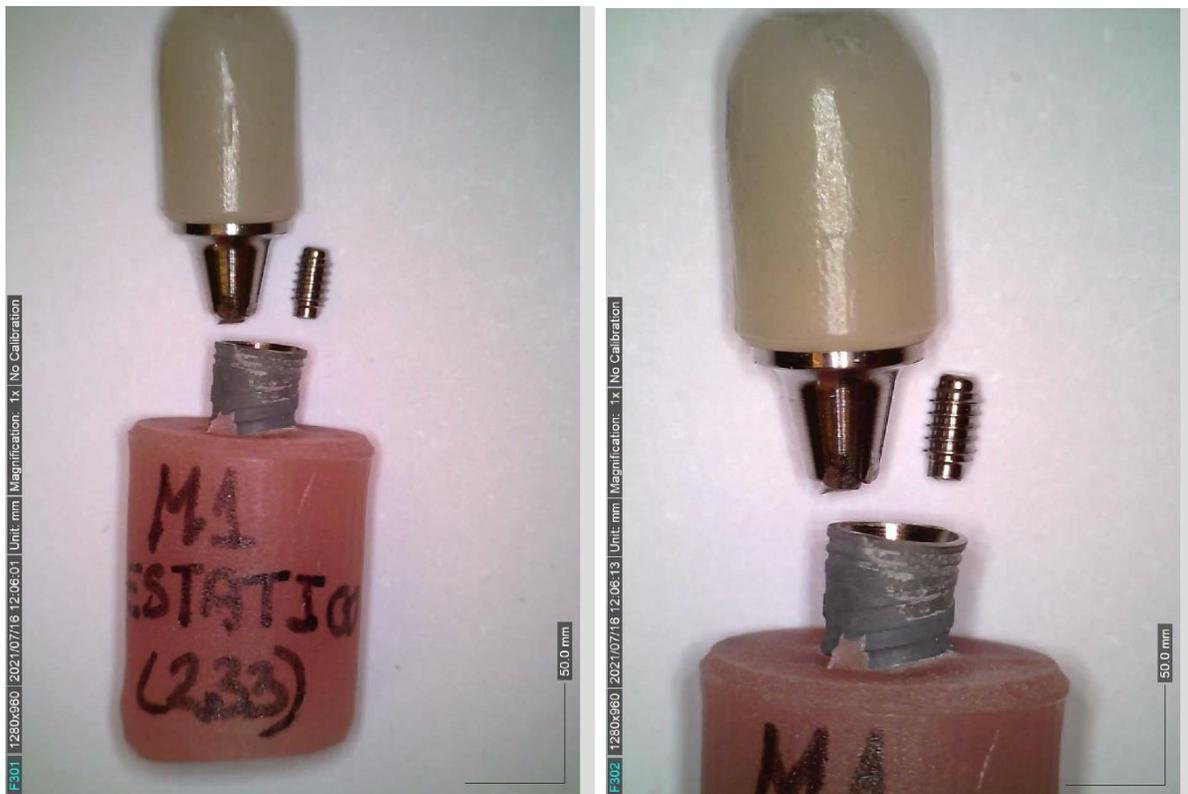
Imagen 3: Fallo de la primera muestra. Ensayo estático. (NB Active NP + NB Multi-Unit 4.8)
