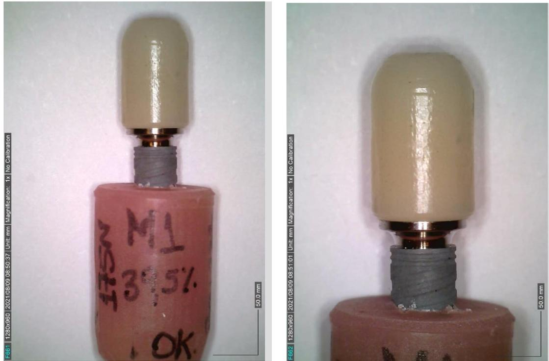
Imagen 8: No hay rotura del conjunto NB Novel Active NP + Multi-Unit 4.8.
